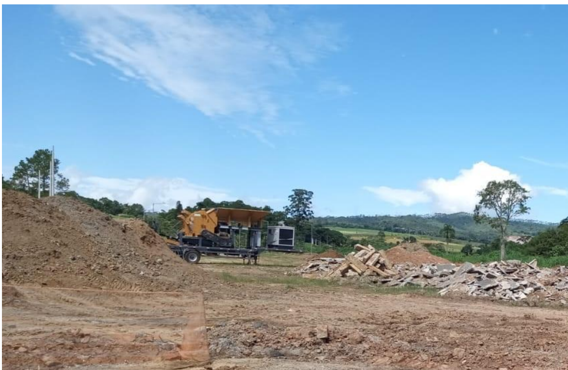
Figura 23: Usina Móvel de reciclagem de resíduos sólidos da construção civil em Biritiba Mirim
